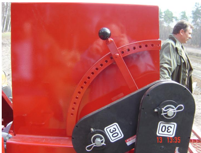
Dźwignia ustawienia wielkości szczeliny pobierania nasion.
