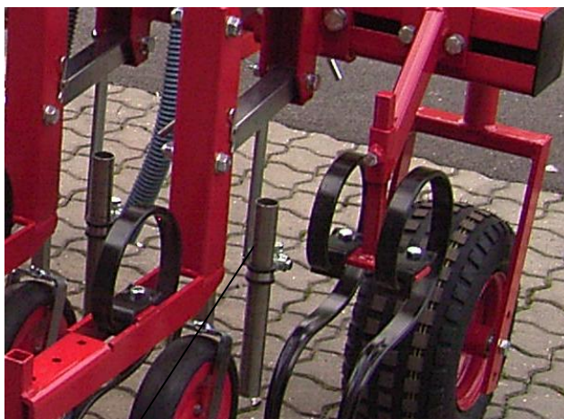
Foto. 2. Budowa rozsiewacza nawozów nabudowanego na kultywatorze typ GS.
