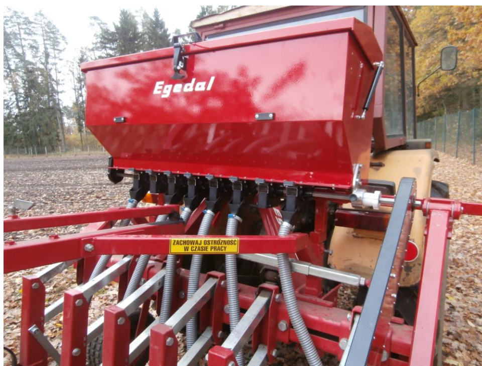
Foto. 1. Rozsiewacz nawozów nabudowany na kultywator typu GS.
