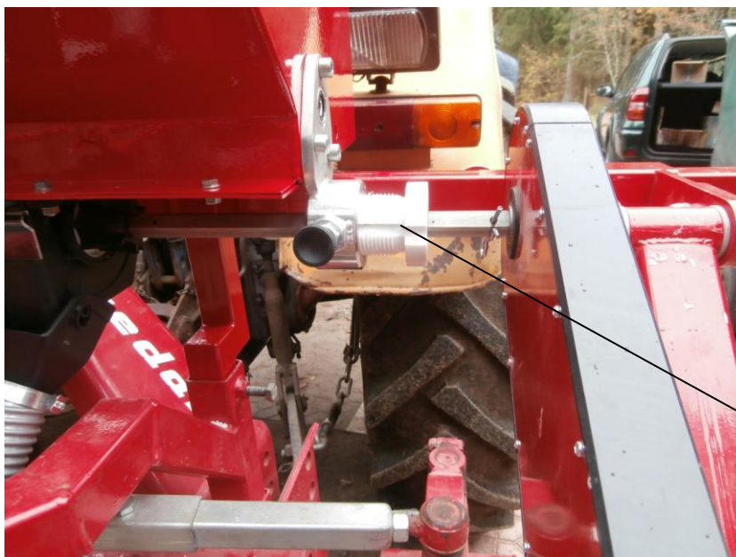
Foto 7. Regulacja dawki wysiewu w mechanizmach wysiewających.
