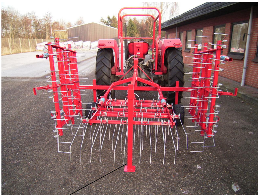
Noga podpierająca używana do składowania maszyny. Na okres pracy noga jest zdejmowana lub podnoszona do góry.
