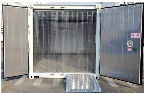
Drzwi z zamkiem, kurtyna paskowa PCV i rampa podjazdowa
